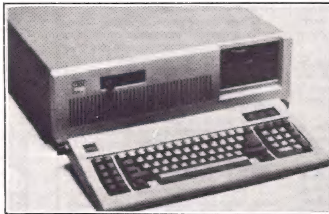
O novo PC AT (Advanced Technology) possui mais memória e teclado aprimorado em relação aos primeiros PCs. O sistema inclui um drive de 1.2 megabyte.
